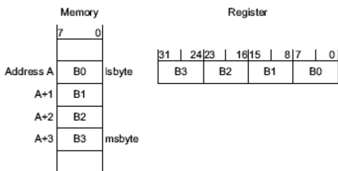
Рисунок 13. Организация расположения байтов в 32-х битной памяти
