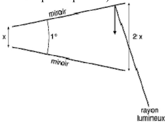
Un rayon lumineux horizontal pénètre entre les deux miroirs, et vient frapper la surface de l'un d'eux.
